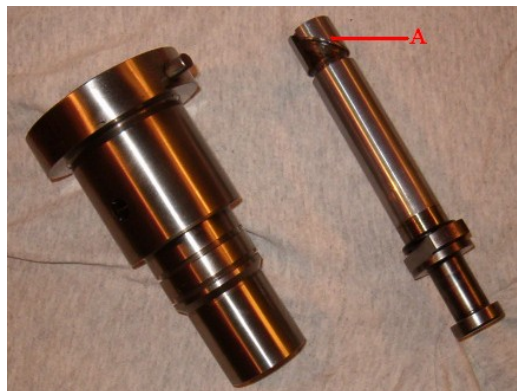
Rys.5. Uszkodzenie krawędzi roboczej nurnika pary precyzyjnej pompy paliwowej (punkt A)
